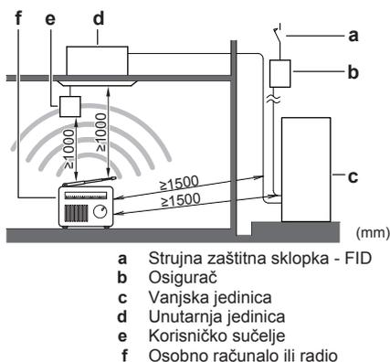
U prostorijama sa slabim prijemom trebate održati udaljenosti od 3 m ili više kako bi se izbjegle elektromagnetske smetnje druge opreme i koristite provodne cijevi za vodove napajanja i prijenosa.
