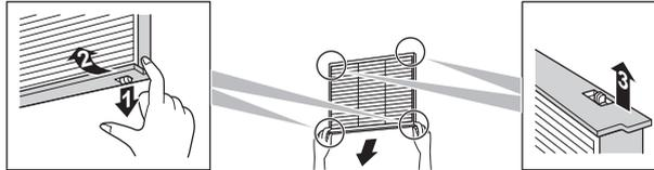
**4** Očistite usisnu rešetku. Operite mekanom četkom i vodom ili neutralnim tekućim deterdžentom. Ako je usisna rešetka vrlo prljava, upotrijebite kuhinjski deterđent i pustite da se odmače 10 min, zatim operite vodom.**5** Ponovo pričvrstite filtar zraka (korak 3 obrnutim redoslijedom).**6** Ponovo pričvrstite usisnu rešetku i zatvorite ju (koraci 2 i 1 obrnutim redoslijedom).
