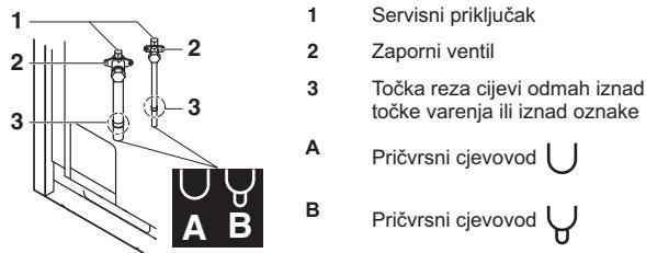
Mjere opreza pri spajajući vanjskih cijevi.
