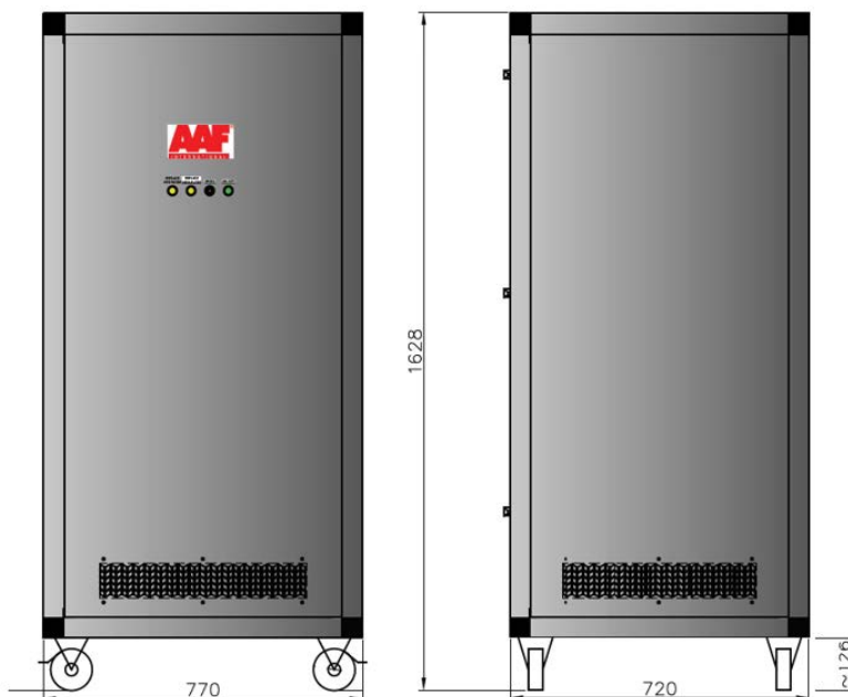
Slika 5 Dimenzije pročišćivača uređaja AstroPure 2000
